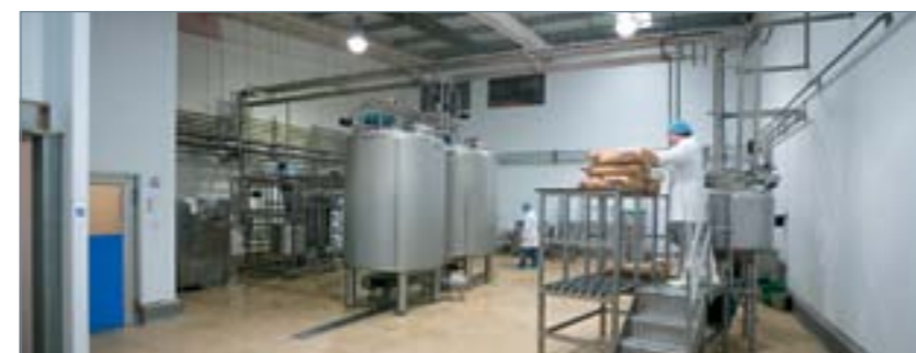
Пищевое производство. Частая влажная уборка и дезинфекция. Гладкая поверхность и герметичность стен.
